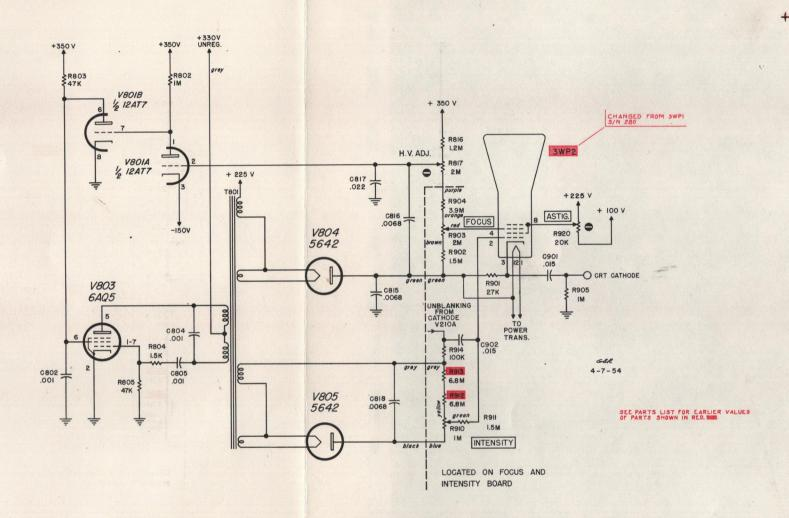
TYPE 315 CATHODE-RAY OSCILLOSCOPE
