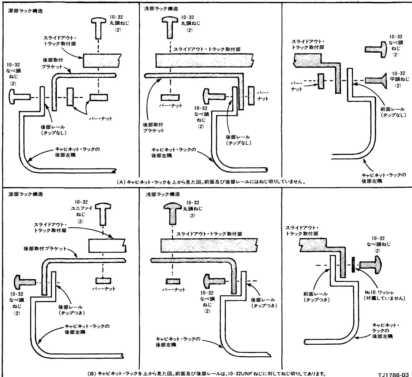
2-2 図 左側取付部(中間部に合わせてあります、図中には示されていません。)のラック・レールへの取り付け。
