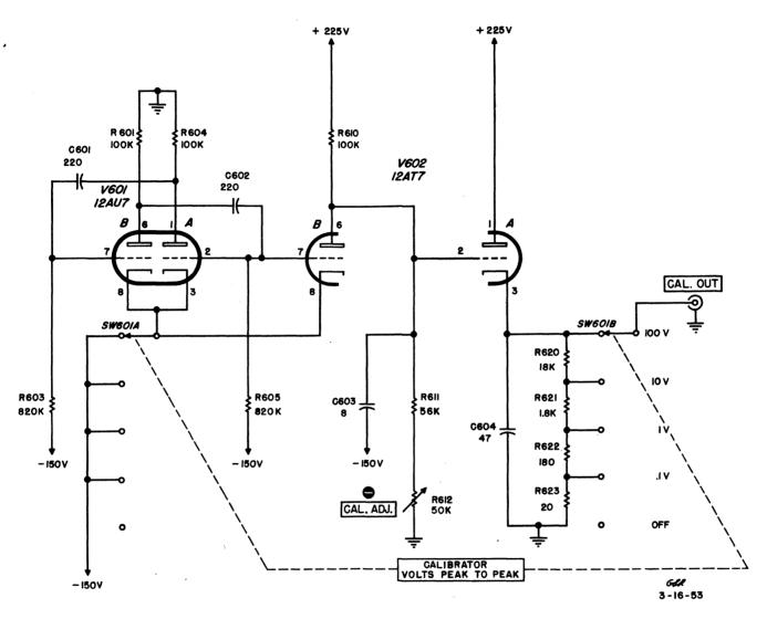
TYPE 315 CATHODE-RAY OSCILLOSCOPE
