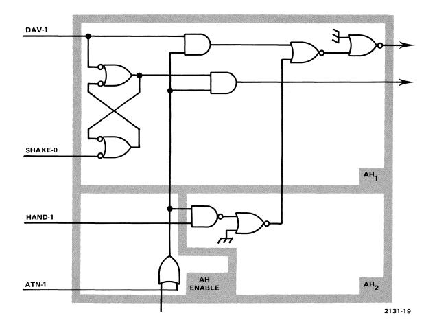
Fig. 5-4. Acceptor Handshake (AH) Block.
