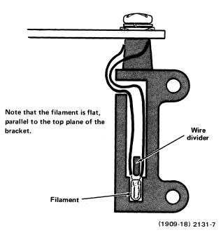
Fig. 3-8. Sensor Lamp Positioning.
