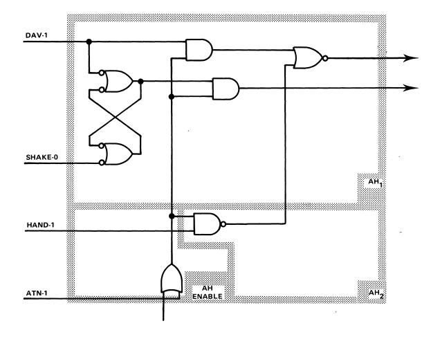
Fig. 5-9. Acceptor Handshake (AH) Block.
