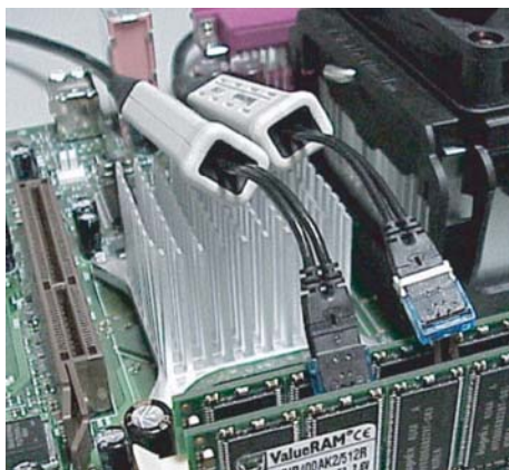
図 20 : Tip-Clip アセンブリを取り付けた回路基板
