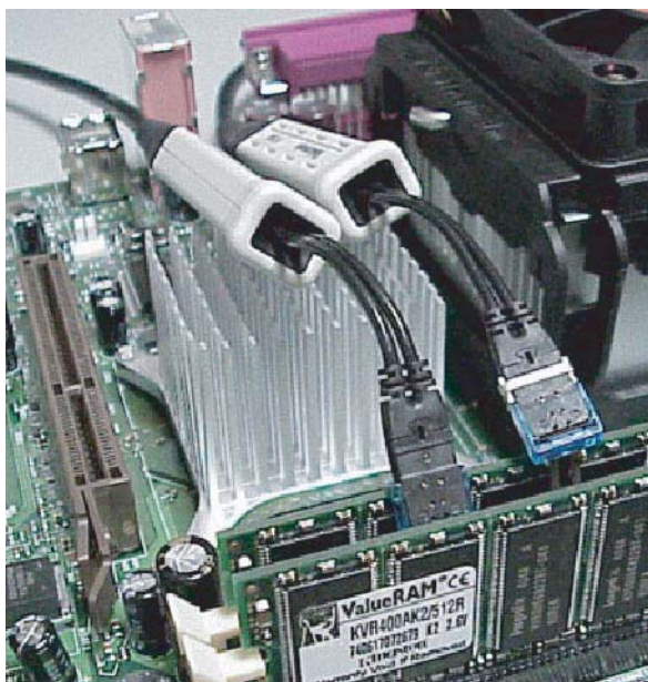
図 10 : ハンダ付けされた Tip-Clip アセンブリ
