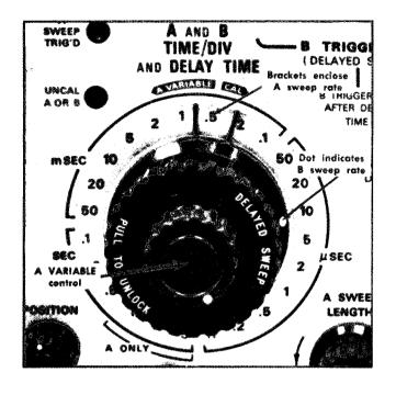
Fig. 2-9. A AND B TIME/DIV switch.
