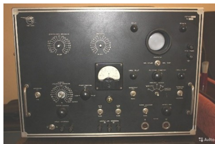
Pulse generator 26I. 1950 r.
