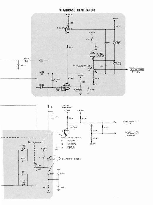
Fig. 5-9. 3T77A Staircase Generator.
