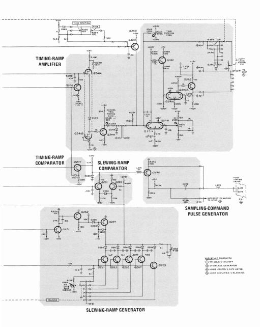
Fig. 6-1. 3T2 Ramp Generators.
