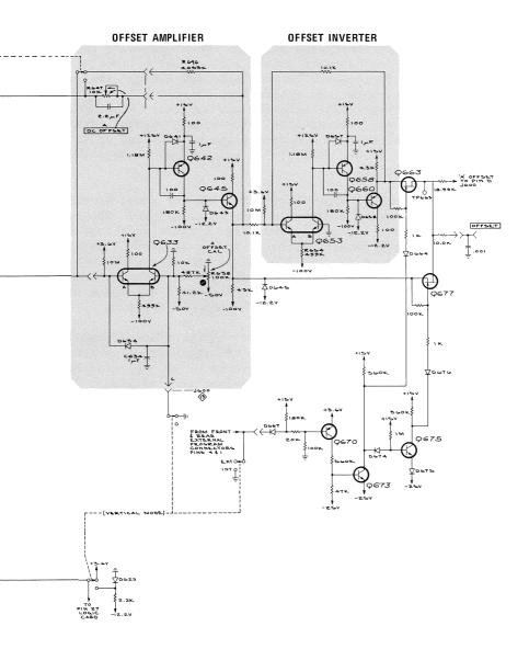
Fig. 3-8. 3S5 Ch A Programmed Offset.
